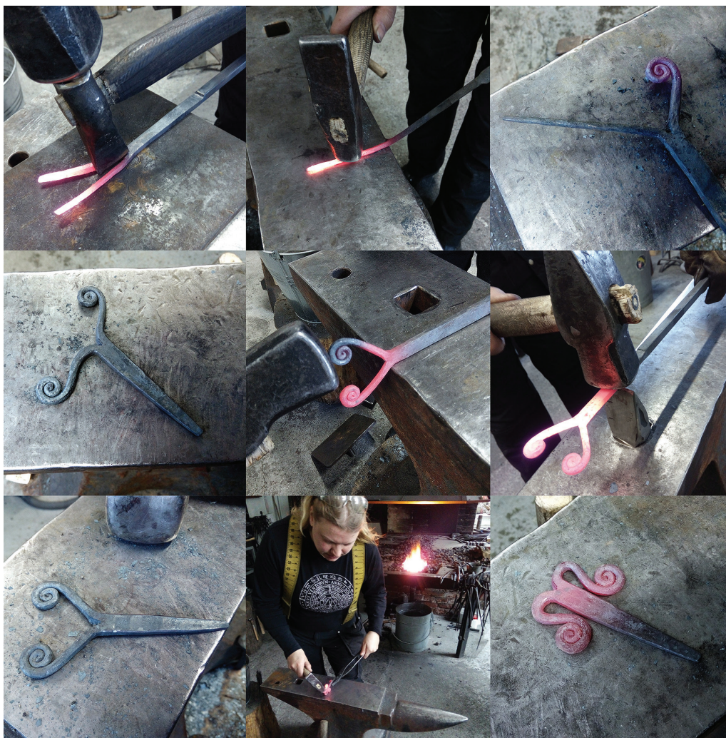
Kuva 4. Strömforsin ruukissa työskentelevä seppä Tiia-Riitta Lahti tutki talvella 2017 kokeellisesti Viirankosken vyökoukun valmistusmenetelmiä. (Kuva: Arttu Halkosaari).
