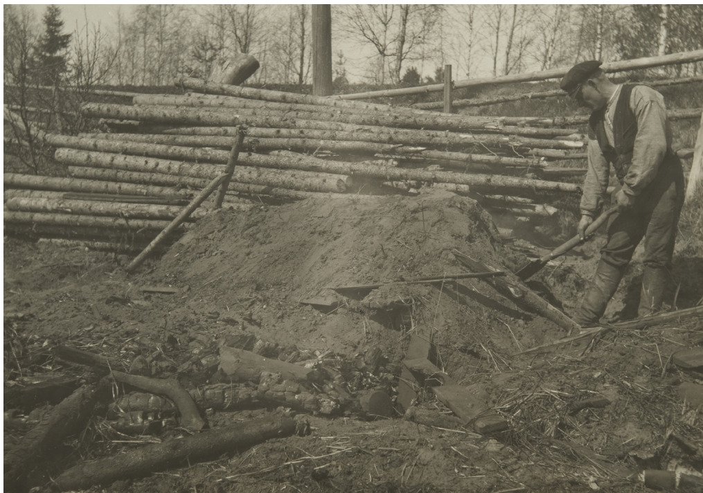
Kuva 3. Multavalla maalla peitetty kuoppamiilu ja hiiltopuita sen takana. (Kuva: A. Rytönen 1926, Museovirasto, Kansatieteen kuvakokoelma, KK1482:219)
